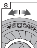
8 Juster den øvre kvernen med 1 grad (tall) for å få grovere eller finere maling
